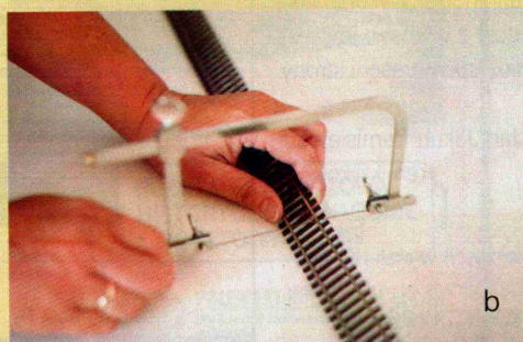
Fot. 1. Cięcie modelowego toru: a) tarczą korundową; b) pilką włosową w ramce.
