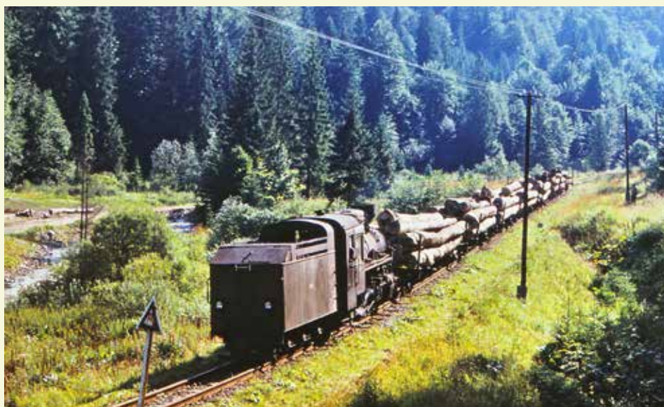
Die Holzzüge der Bieszczady-Waldbahn waren oft lang und schwer. Die kräftige 750-mm-Schleppenderlok Kp 4 bewältigte die hohen Anforderungen, hier bei Moczarne im südöstlichen Teil des Gebirges.
