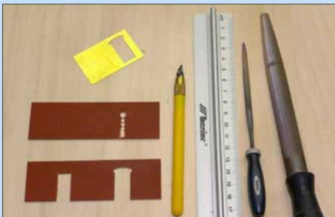
Von der markierten Kontur zur Fensteröffnung: Das Foto zeigt alle Phasen bei der Herausarbeitung der Fensteröffnungen aus der Mauerfläche.
