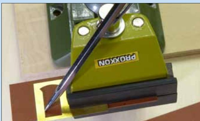
Der Schraubstock mit Gummiauflagen auf seinen Backen sichert einen festen, zugleich aber sicheren Halt beim Anzeichnen der Fensteröffnungen mithilfe von Schablonen aus Ätzblech.
