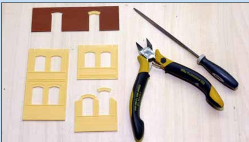
Teile aus dem Baukastensystem von Auhagen spenden die Fensterstürze für die neuen Fensteröffnungen. Die Gewölbeform der Stürze verlangt ein sehr genaues Arbeiten, da hier spätere Korrekturen so gut wie ausgeschlossen sind.
