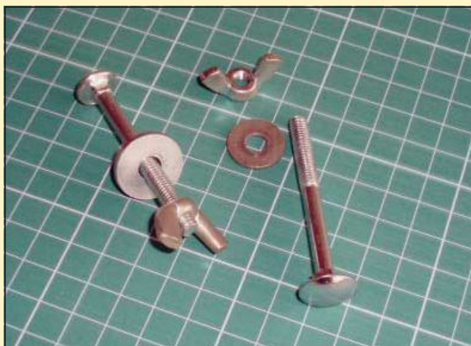
Fot. 3. Śruby z podkładkami i nakrętkami motylkowymi do łączenia segmentów makiety.
