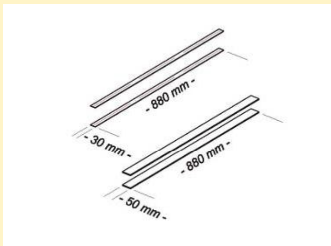
Rys. 7. Paski płyty pilśniowej i kartonu imitujące torowisko i „falszywą” podsypkę.
