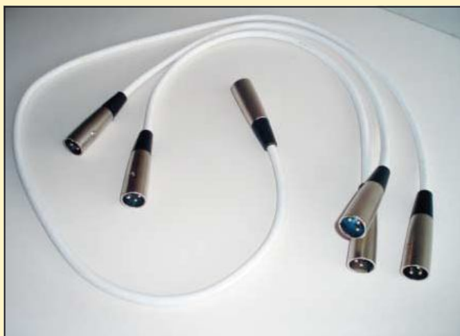
Fot. 6. Przewody połączeniowe z wtykami XLR (dłuższy przewód – z połączeniem „skrosowanym”).
