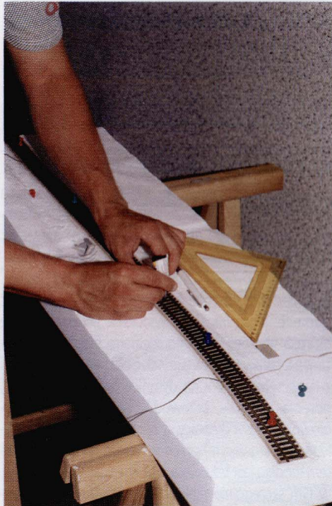
Fot. 5 Układanie toru kolejowego. Pod torom widoczny pas tekstury imitujący podsypkę pod podkładami. Tor umocowany pinezkami. Trwa przyklejanie toru klejem cyjanoakrylowym.
