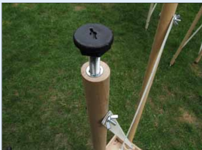
Als Kabelhalterung dient eine Wäscheklammer. Die Flügelmuttern der Stützeinklemmen wurden mit kurzen Schrumpfschlauchstücken zum Schutz vor Verletzungen überzogen.
