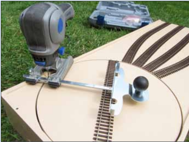
Mithilfe dieses Dremel-Werkzeugs gelingt ein exakt maßhaltiger Kreisausschnitt. Am besten sucht man dazu einen Tischler auf, der dieses oder vergleichbar anspruchsvolles Werkzeug besitzt.
