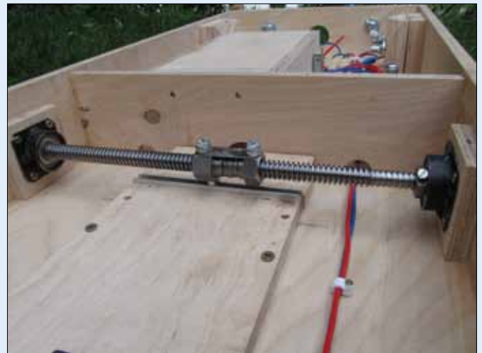
Der Antrieb des Drehwinkels erfolgt über eine Welle mit Trapezgewinde 12x3 aus dem Maschinenbau. Die Weichenverschiebung wird über eine Mutter 12x3 mit eingeschraubtem Bolzen bewirkt.
