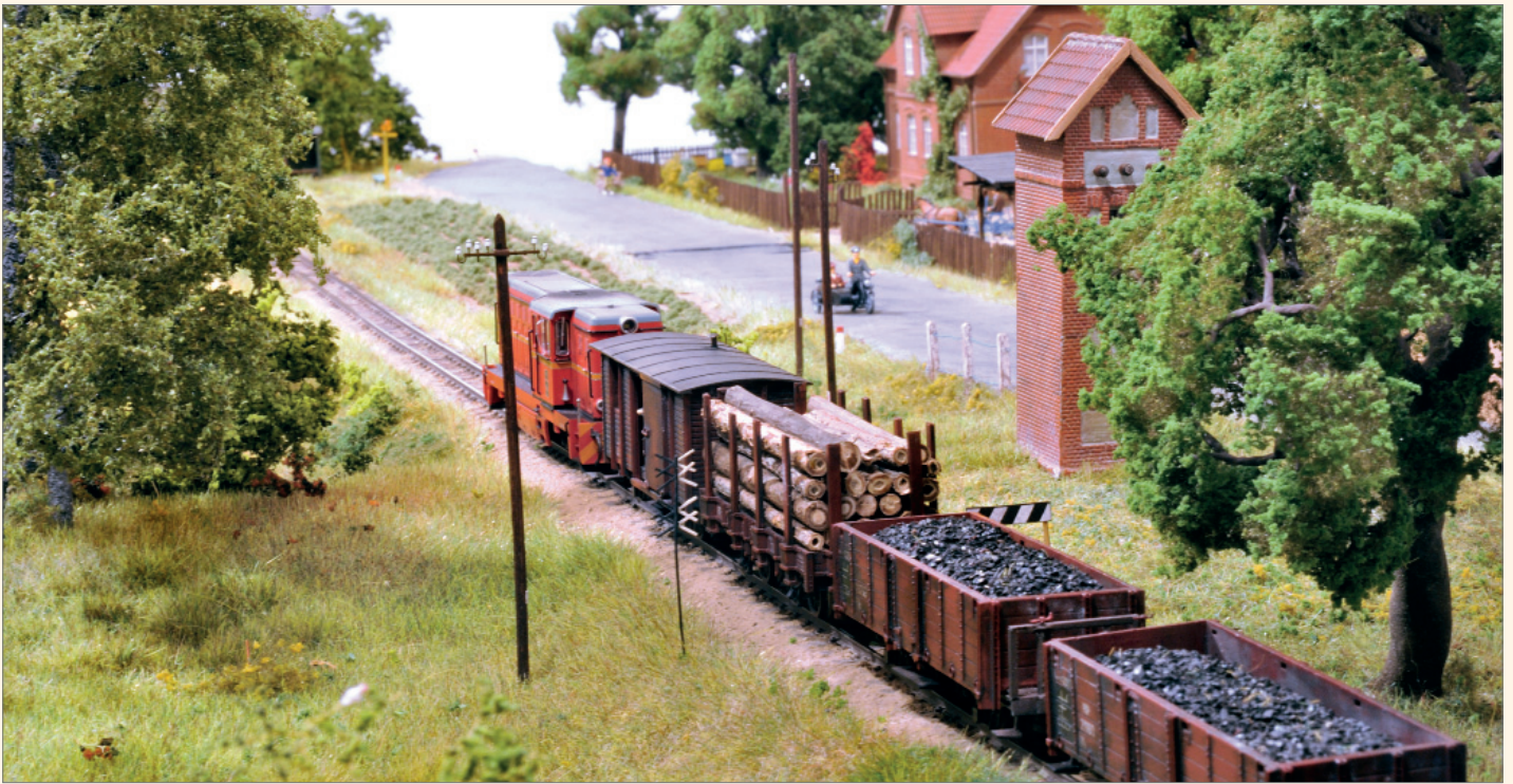
Oft waren die Schmalspur-Güterzüge in Polen durch mit Kohle und Holz beladene Wagen geprägt, im Herbst dann vornehmlich durch Rüben- und Kartoffelbeladung. Hier zieht eine Diesellok der Baureihe Lxd2 einen Güterzug mit Kohle- und Holzwagen.
