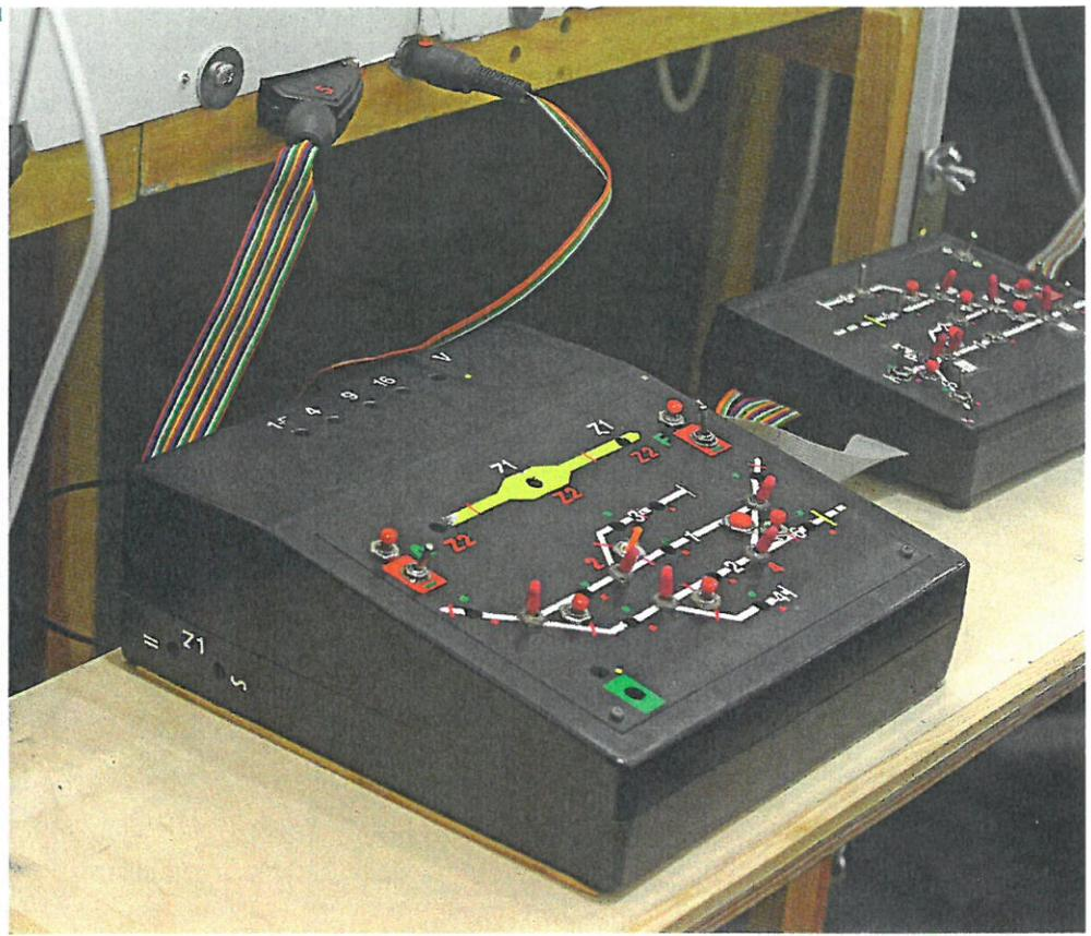
Die Stellpulte, links für den Schmalspur-, rechts für den Regelspurteil von Lewin-Leski, sind im Eigenbau entstanden. Alle Weichen und Signale werden von hier aus analog gestellt. Die Schalterstellungen geben über den jeweils aktuellen Zustand Auskunft.
