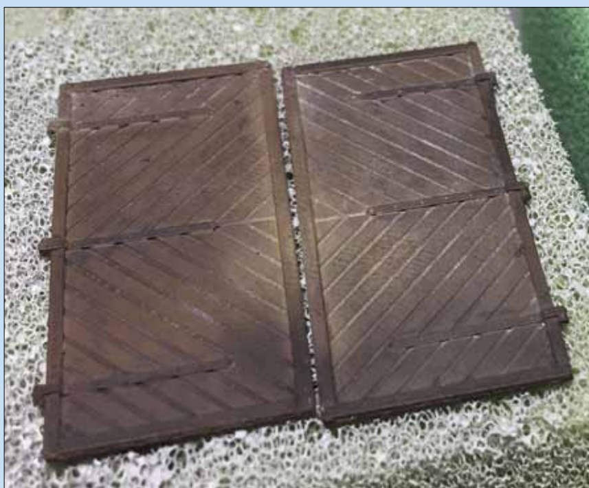
Die aus Kupferblech vierschichtig zusammengelöteten Torflügel, die hier zum Auftrocknen (der Farbe) auf der Leine hängen, müssen vor der „Holzpatinierung“ grundiert werden.
